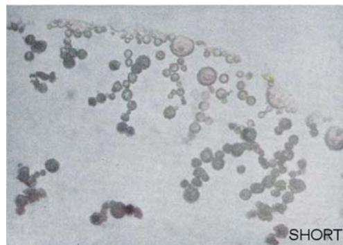
Sphérules de thiocyanatomercurates de cobalt et de nickel à partir d'une solution à 0,5 % de nitrate de cobalt et à 0,5 % de nitrate de nickel ; les deux précipités sont présents. X 210
